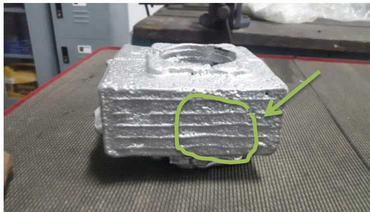
Gambar 4.6. Cacat lubang jarum dan lekat pada blok silinder
