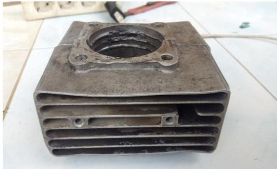
Gambar 3.5. Blok mesin Satria 2 tak
