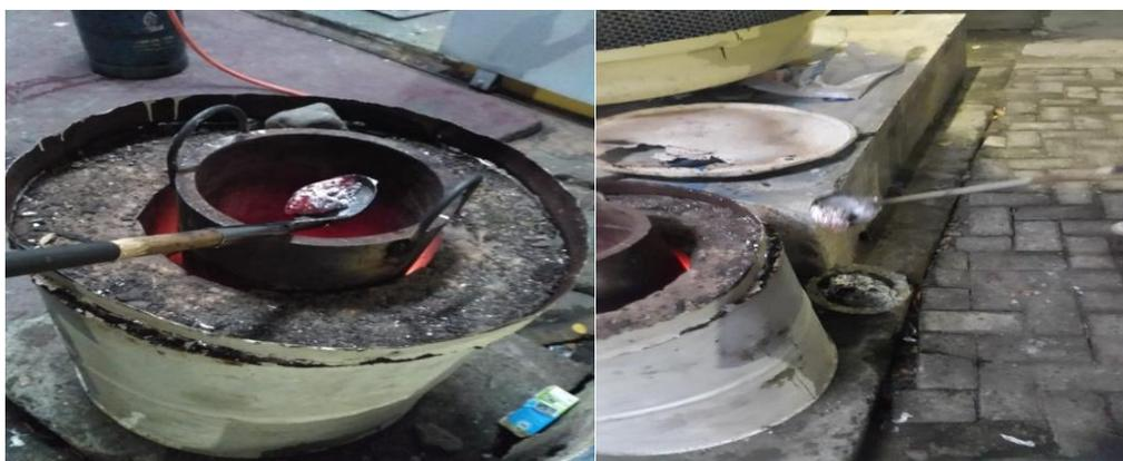
Gambar 3.30. Pengambilan dross yang terlebur dalam aluminium
