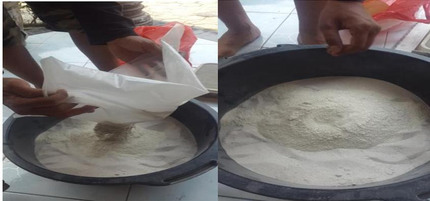
Gambar. 3.21. Proses pencampuran pasir dan bentonite
