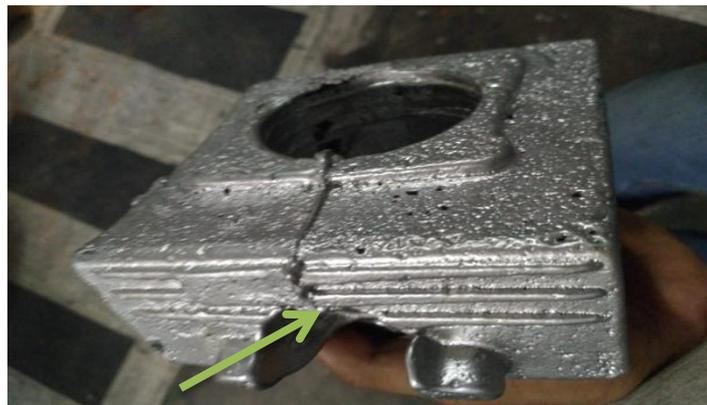
Gambar 4.8. Salah aliran dan sumbat dingin pada blok silinder
