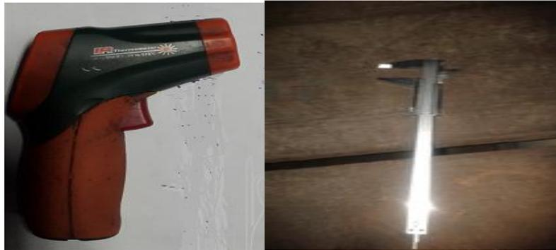
Gambar 3.11. Termometer laser dan jangka sorong
