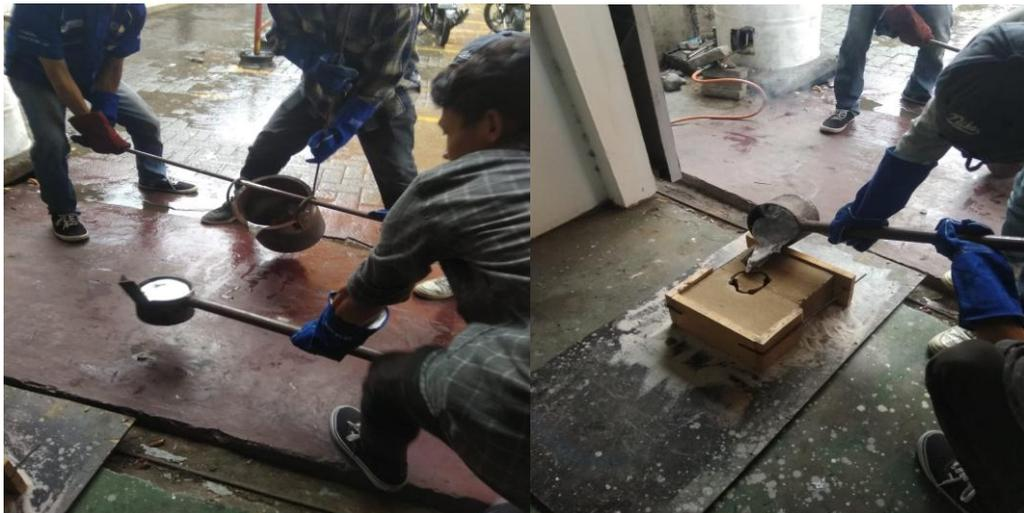
Gambar 3.33 Penuangan Aluminium ke cetakan pasir
