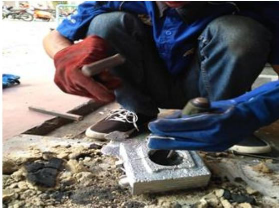
Gambar 3.33. Pembongkaran cetakan pasir
