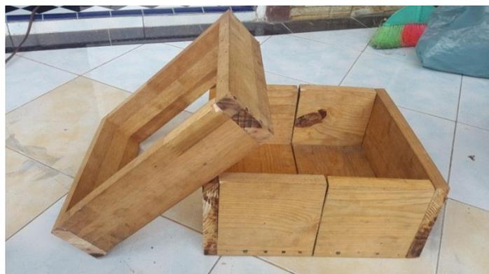
Gambar 3.6. Kotak Molding
