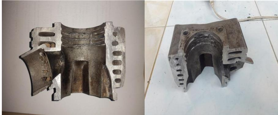
Gambar 3.14. Blok silinder yang terpotong
