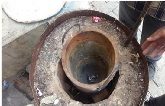
Gambar 3.27. Proses memasukan aluminium kedalam tungku lebur
