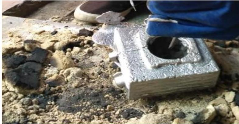
Gambsar 4.2. Cetakan pasir yang mengeras setelah penuangan
