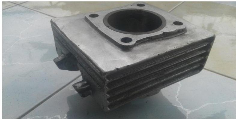
Gambar 4.11. Blok silinder setelah *finising*
