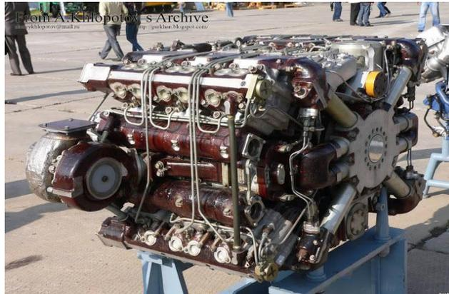
Gambar 2.10. Mesin X tipe
