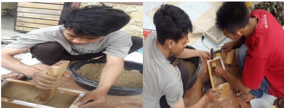
Gambar 3.24. Proses pemadatan pasir ke dalam mol
