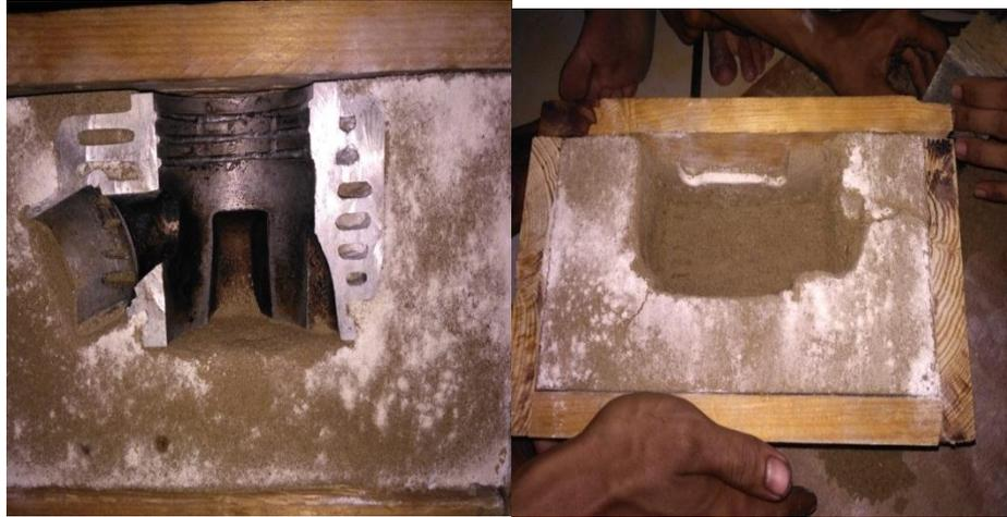
Gambar 3.25. Proses pengangkatan blok
