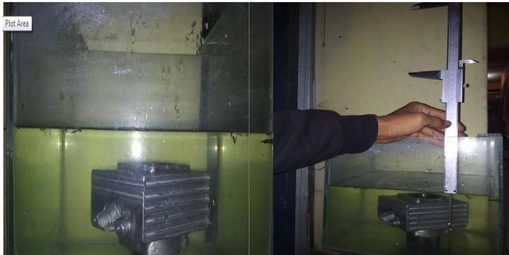
Gambar 4.19. Pengukuran blok silinder dalam air
