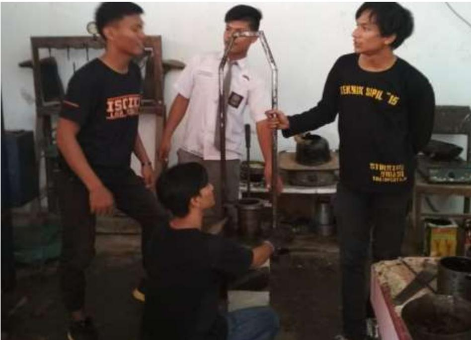
Gambar L6: Penumbukan benda uji
