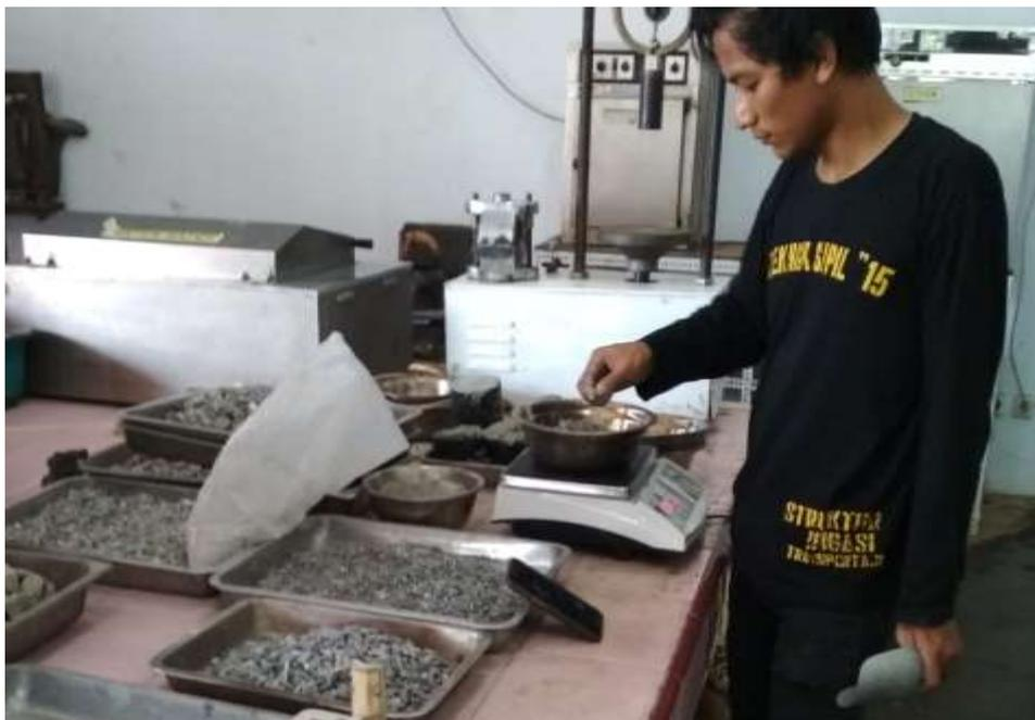
Gambar L4: Mencampur agregat halus, agregat kasar, Serat daun nanas sebelum dipanaskan dan dicampur dengan aspal.
