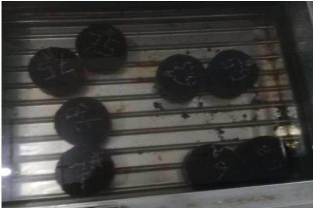
Gambar L8: Pengujian Waterbath.
