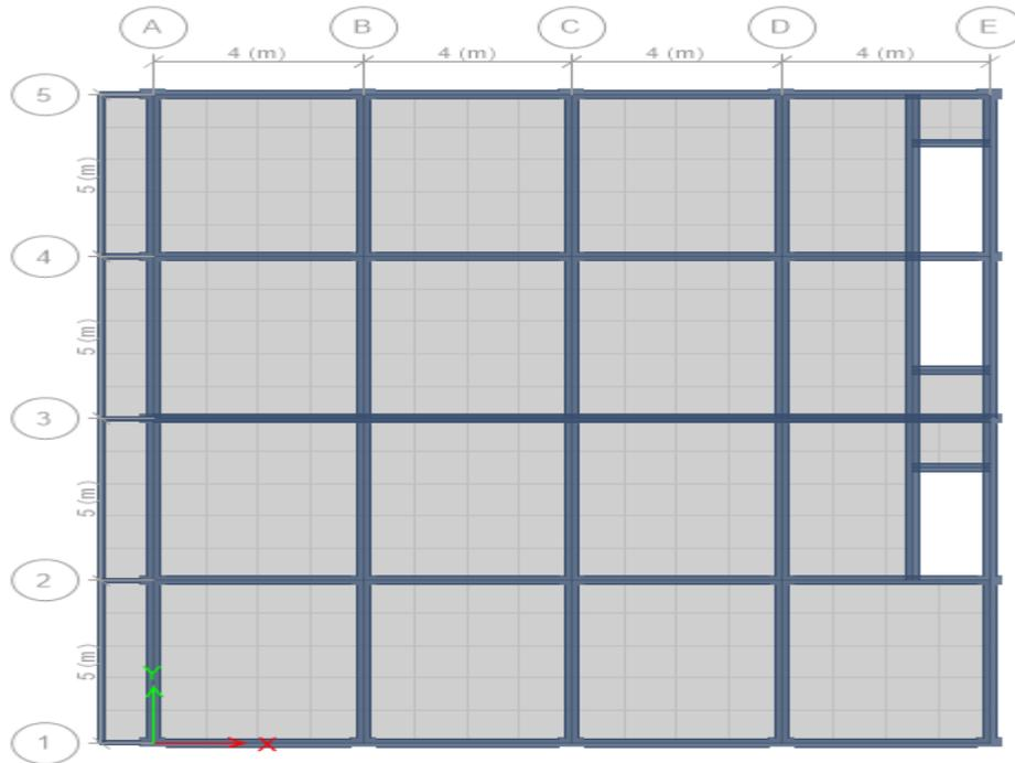
Gambar 3.6: Denah struktur beton Model 2 di lapangan.
