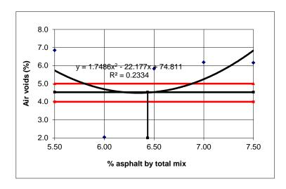
Gambar 4.7: Grafik hubungan antara kadar aspal (%) dengan *Air Voids* (VIM) (%) Serat daun nanas 0,3%
