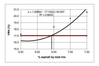
Gambar 4.9: Grafik hubungan antara kadar aspal (%) dengan VMA (%) Serat daun nanas 0,3%
