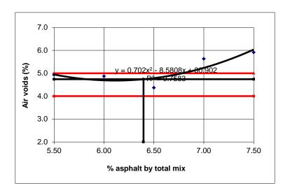
Gambar 4.6: Grafik hubungan antara kadar aspal (%) dengan *Air Voids* (VIM) (%) *C*ampuran normal.
