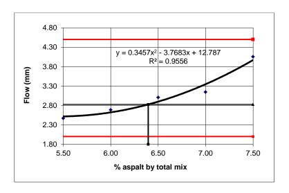
Gambar 4.10: Grafik hubungan antara kadar aspal (%) dengan *Flow* (mm) Campuran normal.
