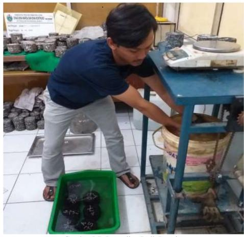
Gambar L7: Pengujian Bulk Density
