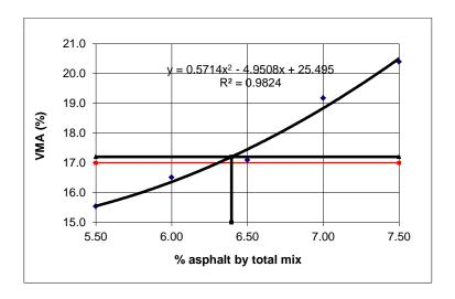
Gambar 4.8: Grafik hubungan antara kadar aspal (%) dengan VMA (%) Campuran normal.
