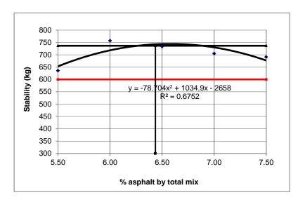
Gambar 4.5: Grafik hubungan antara kadar aspal (%) dengan *Stability* (Kg) Serat daun nanas 0,3%.
