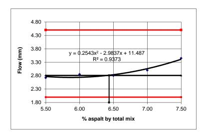
Gambar 4.9: Grafik hubungan antara kadar aspal (%) dengan *Flow* (mm) Serat daun nanas 0,3%
