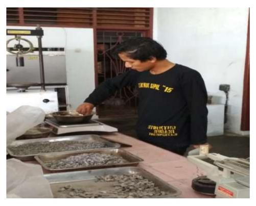
Gambar L4: Mencampur agregat halus, agregat kasar, Serat daun nanas sebelum dipanaskan dan dicampur dengan aspal.
