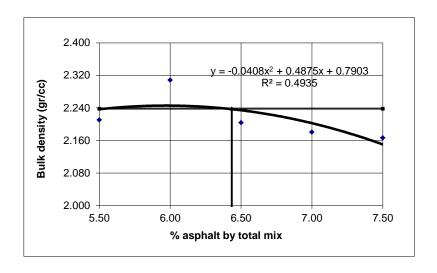
Gambar 4.3: Grafik hubungan antara kadar aspal (%) dengan  $Bulk\ Density$  (gr/cc) Serat daun nanas 0,3%.
