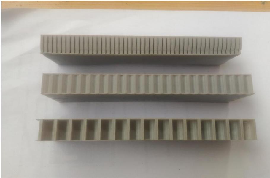
Gambar 4.8 Hasil pembuatan spesimen Honeycomb
