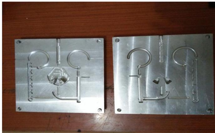
Gambar 4.3. Hasil pengerjaan perancangan cetakan (*mold*)
