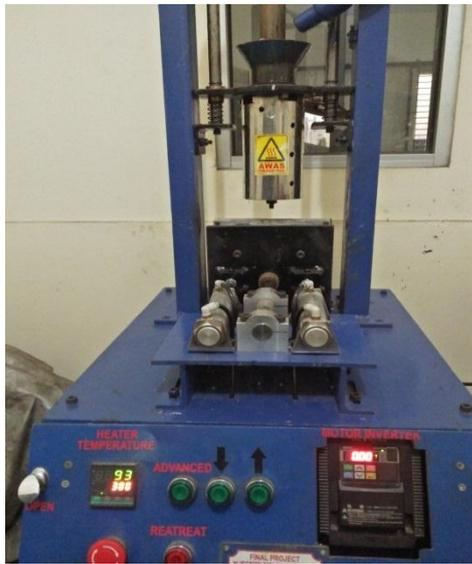
Gambar 3.24. Pengujian cetakan pada mesin cetak injeksi moulding
