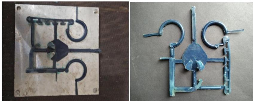
Gambar 4.4. Hasil dari proses pencetakan
