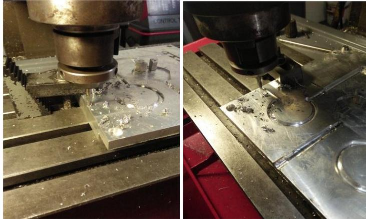
Gambar 3.22. Proses pembuatan alur masuk dan alur keluar
