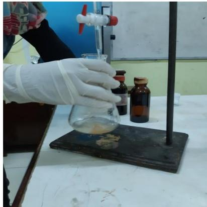
Gambar 43. Titrasi dengan  $\text{Na}_2\text{S}_2\text{O}_3$
