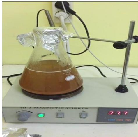
Gambar 46. Homogenkan dengan Magnet Stirrer
