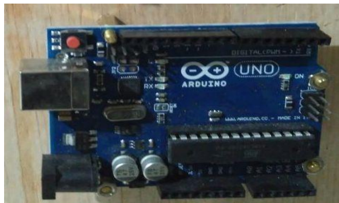
Gambar 4.1 Rangkaian Arduino Uno Mikrokontroler Atmega 328
