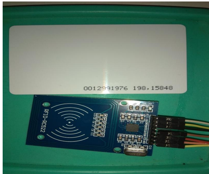
Gambar 4.3 Rangkaian RFID reader dan RFID tag.
