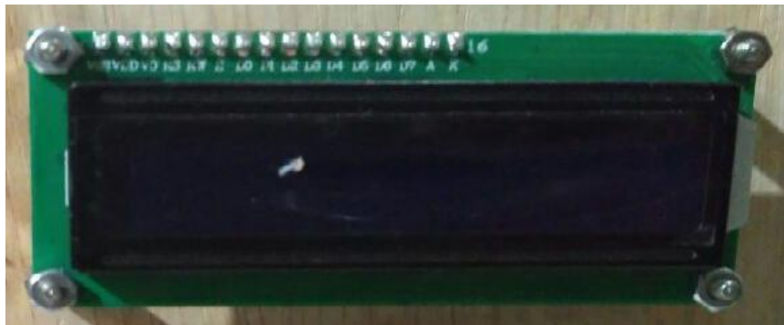
Gambar 4.2 Rangkaian LCD karakter 16x2
