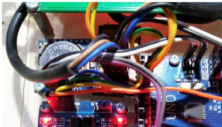
**Gambar 4.4 Rangkaian Modul RTC DS1307**
