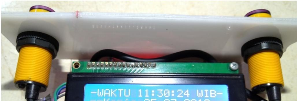
**Gambar 4.3 Pemasangan Sensor Proximity**
