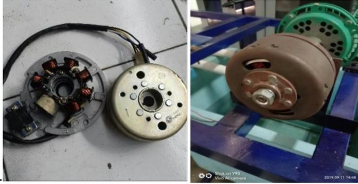
Gambar 3.6. Magnet dan spul motor
