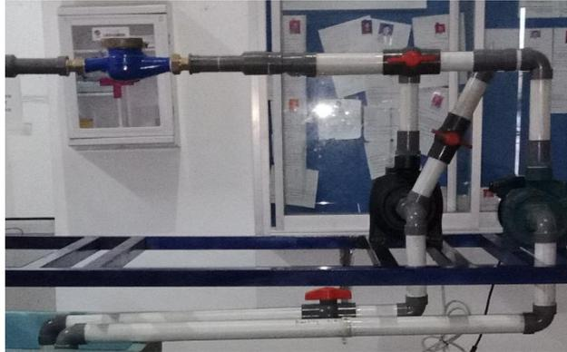
Gambar 3.16 Rangkaian Susunan parallel
