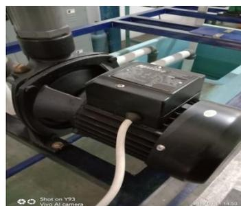
Gambar 3.2. pompa sentrifugal
