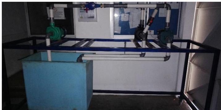
Gamabar 3.13 Rangkaian pemasangan pipa pada turbin
