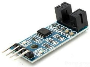
Gambar 2.15. Sensor Kecepatan
