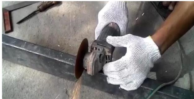
Gambar 4.16 Pemotongan bahan *fork*
