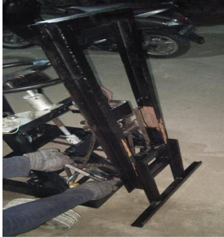
Gambar 4.24 Pemasangan *mast* dan *carriage* terhadap *chasis* atau rangka
