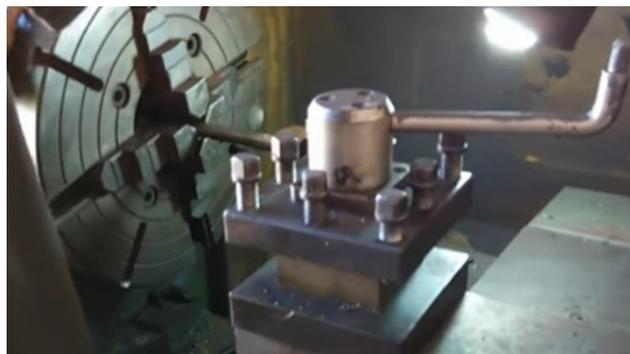
Gambar 4.21. pembubutan poros roda *forklift*
