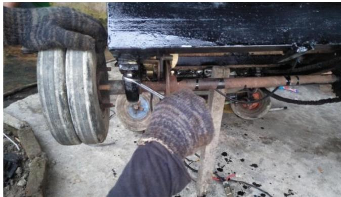
Gambar 4.23 Pemasangan poros dan roda
