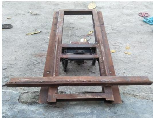
Gambar 4.12. Hasil pembuatan *mast* dan *carriage*.
