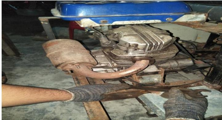
Gambar 4.26 Pemasangan motor penggerak atau mesin
