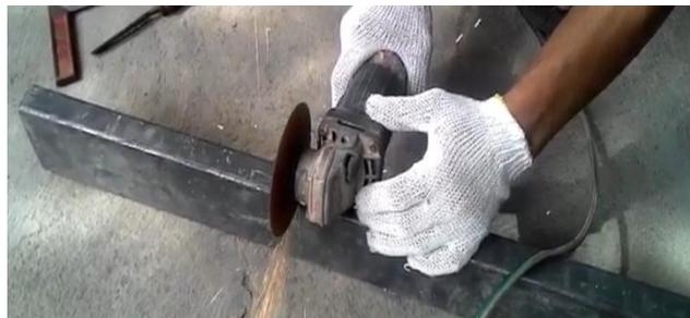
Gambar 4.10 Pemotongan bahan *mast* dan *carriage* menggunakan gerinda
