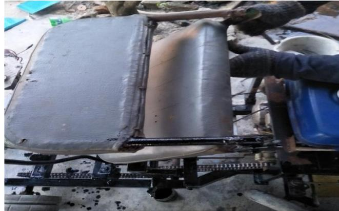
Gambar 4.28 Pemasangan bangku oprator
