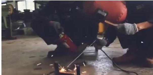
Gambar 4.18. Penyambungan bahan pembuatan *fork* menggunakan mesin las
