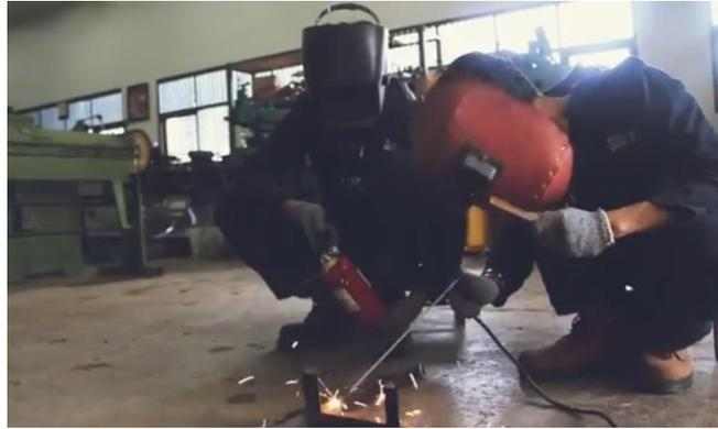
Gambar 4.5 Proses penyambungan bagian *chasis*
