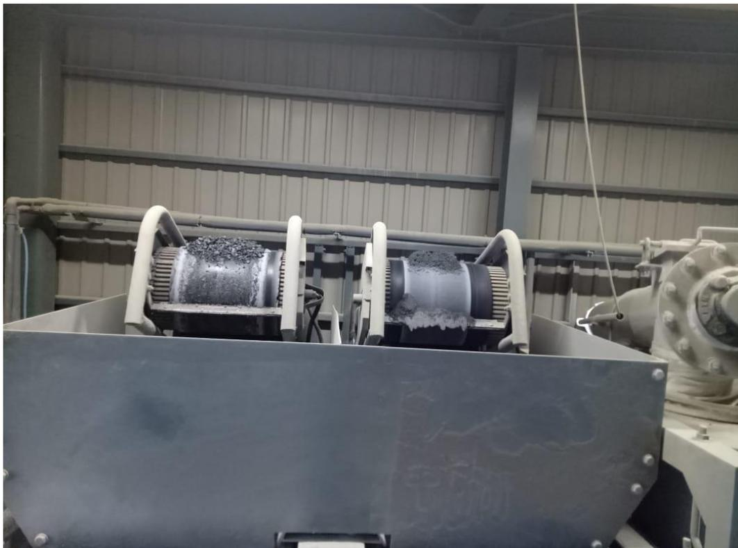
Gambar 4.9: Penghantar agregat kasar dan agregat halus.
