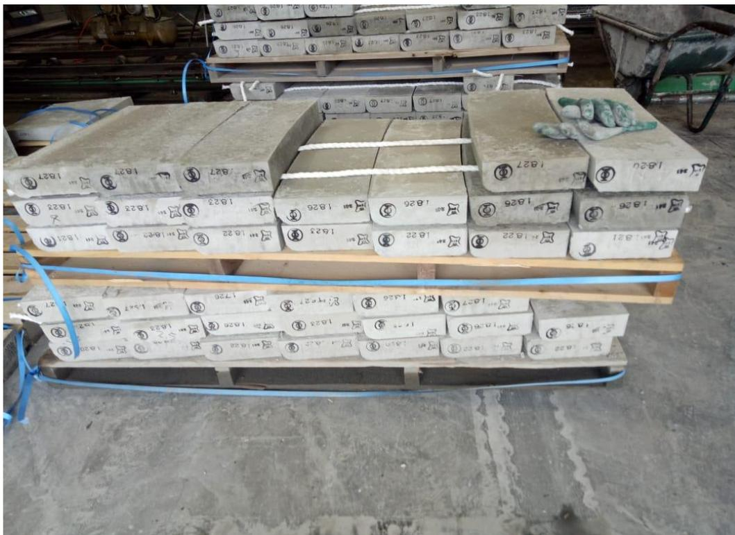
Gambar 4.22: *Precast pagar panel* yang telah ditumpukkan di area gudang.
