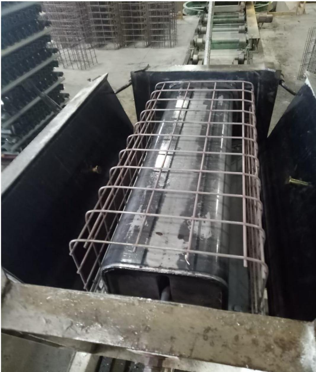
Gambar 4.11: *Moulding*/cetakan yang digunakan Ilcon Industrial.
