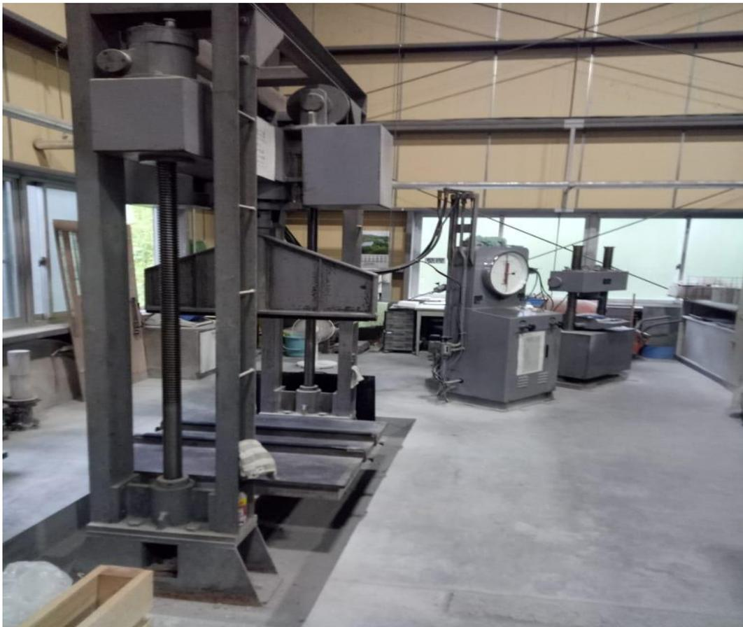
Gambar 4.13: Alat uji kuat tekan beton yang digunakan Ilcon Industrial.
