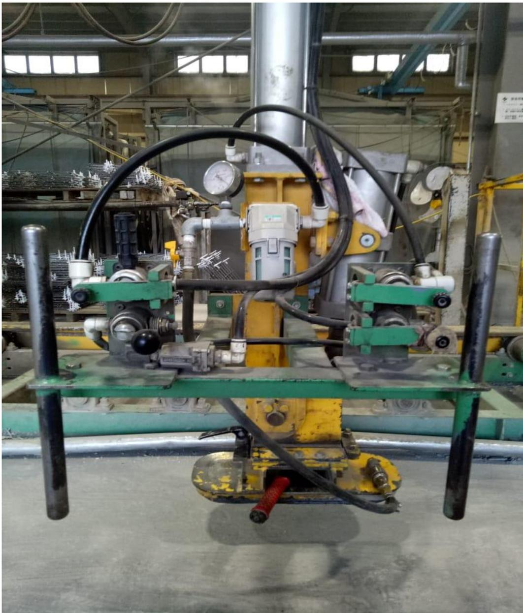
Gambar 4.20: Alat penghisap beton yang berfungsi mengangkat beton yang sudah kering dan dilepaskan dari cetakan/ *moulding*.
