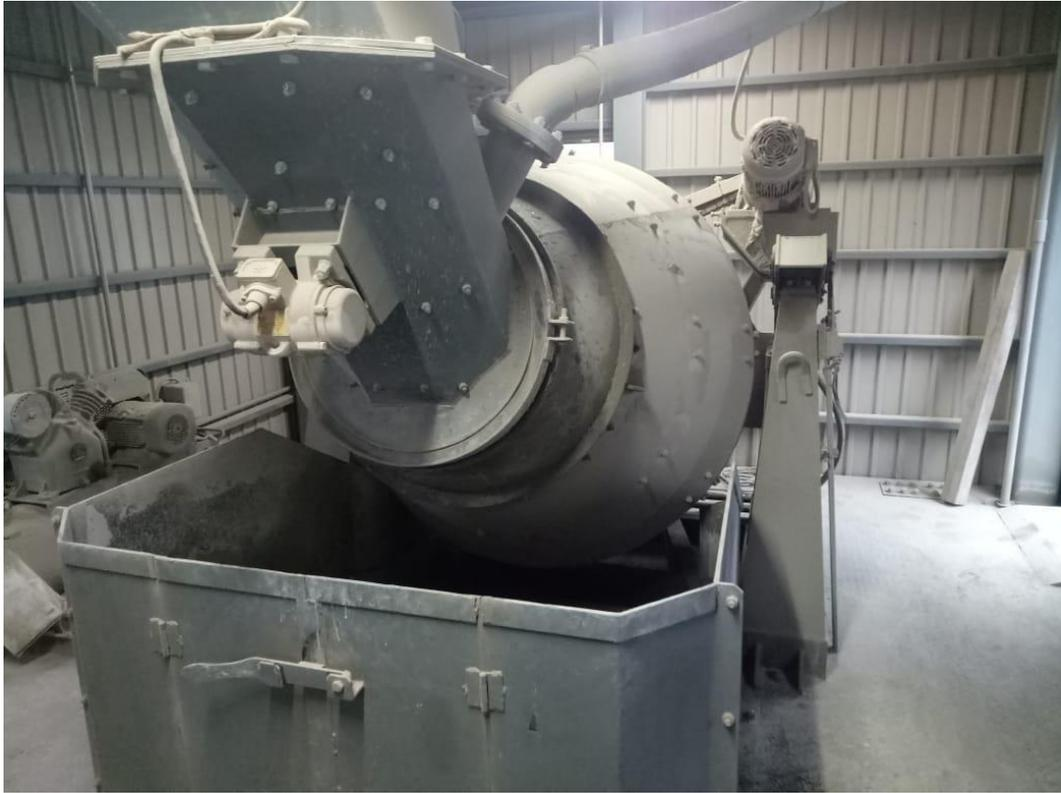
Gambar 4.10: *Mixer* yang digunakan Ilcon Industrial.
