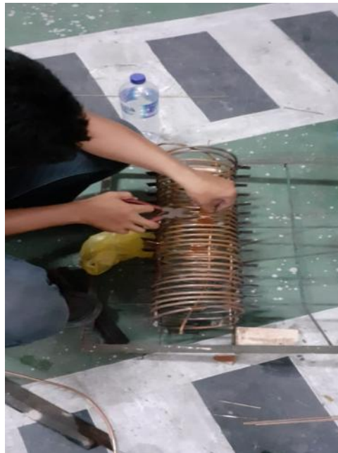
Gambar 4.10 Proses Pemasangan Sirip Terhadap APK
