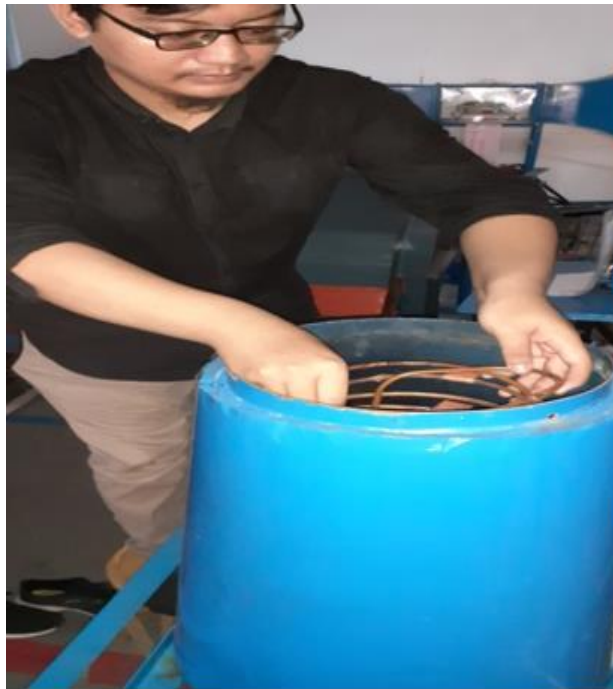
Gambar 4.13 Pemasangan Helical Coil ke Dalam Tangki
