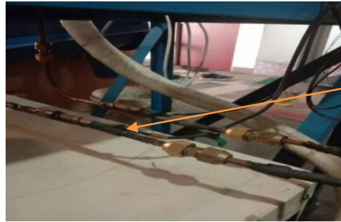
Gambar 4.25. Sensor Suhu Masuk Kondensor
