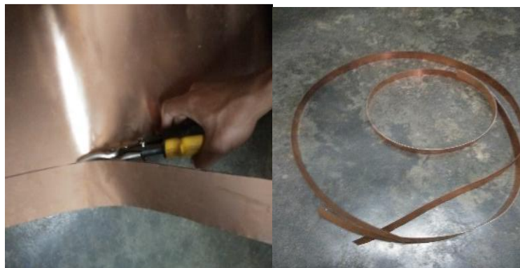
Gambar 4.8 Pemotongan Pelat Tembaga
