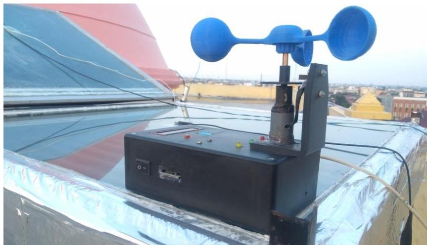
Gambar 3.4. Thermo Anemometer.
