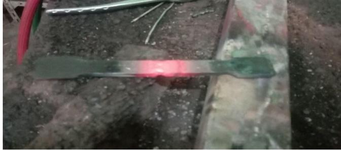
Gambar 4.8 Hasil Pengelasan Terhadap Spesimen
