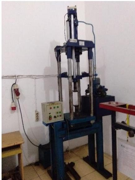
Gambar 4.9 Mesin Uji Tarik dan Kelengkapannya
