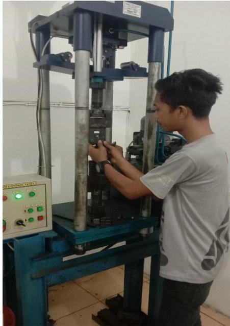
Gambar 4.12 Mengikat Spesimen
