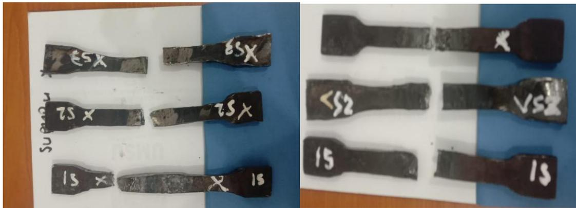
Gambar 4.14 Patahan Spesimen Hasil Pengujian Tarik
