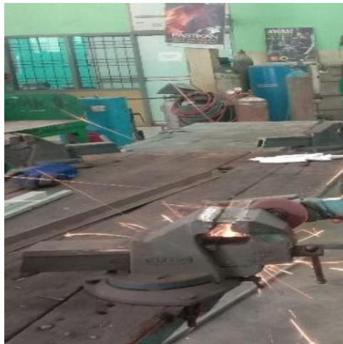
Gambar 4.2 Memotong Plat Baja
