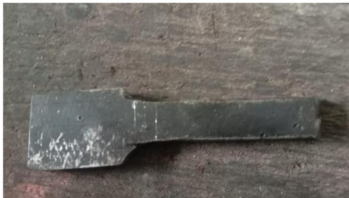
Gambar 4.4 Gambar Spesimen Sebelum Pembuatan Kampuh
