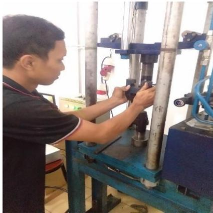
Gambar 4.13 Mengikat Spesimen
