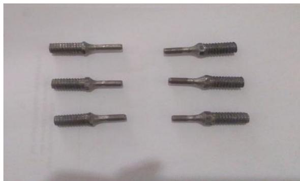
Gambar 4.5 Spesimen setelah dibubut
