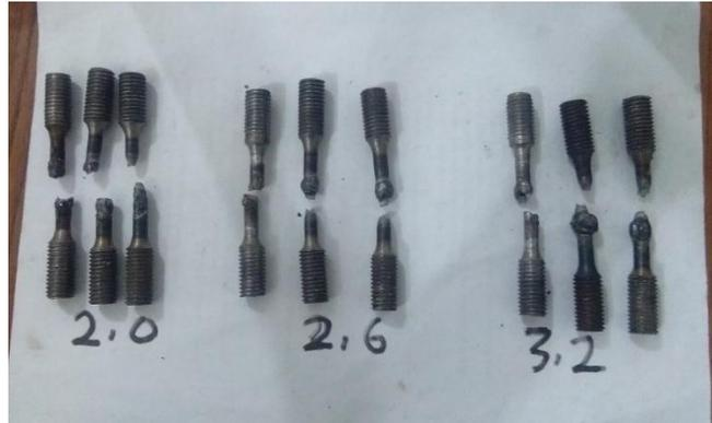
Gambar 4.15 Patahan Spesimen Hasil Pengujian Tarik
