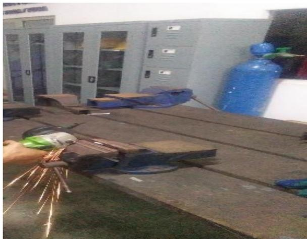
Gambar 4.2 Memotong Spesimen
