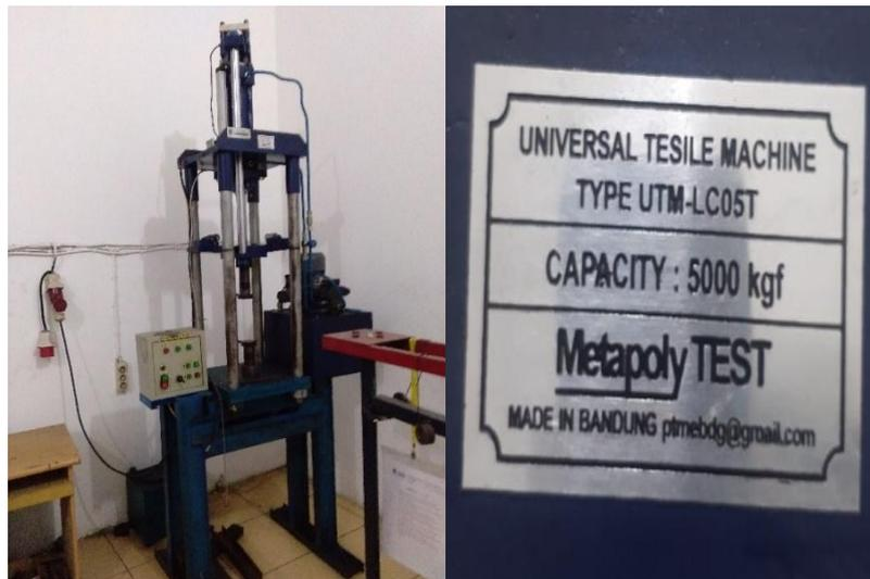
Gambar 4.9 Mesin Uji Tarik dan Kelengkapannya
