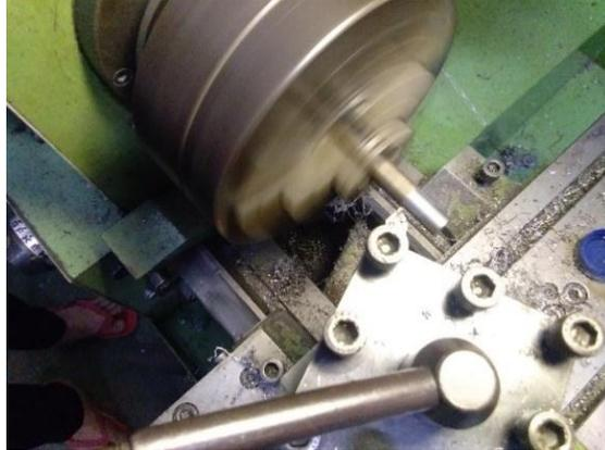
Gambar 4.3 Membubut Spesimen
