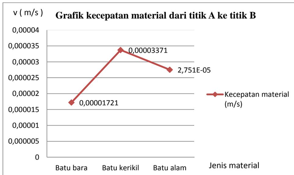
Gambar 4.4. Grafik nilai kecepatan material batubara, batu kerikil, dan batu alam dari titik A ke titik B.
