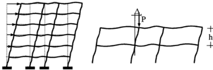
Gambar 2.9: Simpangan bangunan dan drift index .
