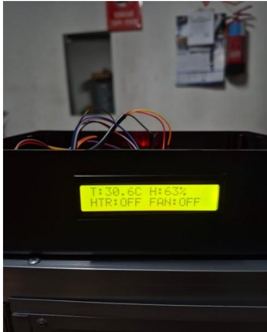
Gambar 4.3 Tampilan LCD saat berjalan
