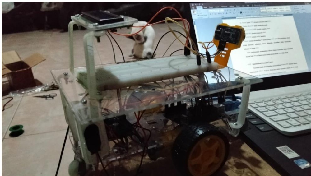
Gambar 4. 1 Implementasi Perangkat Keras
