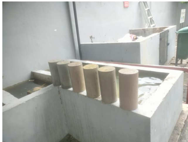
Gambar.L. 10 Pemeriksaan beton setelah perendaman umur 28 hari
