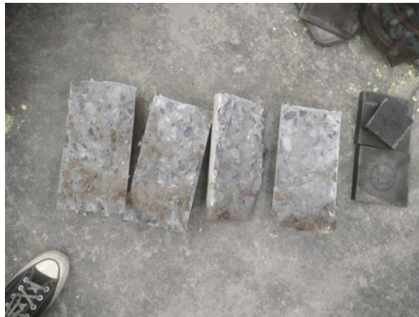
Gambar.L. 13 Sampel beton setelah pengujian
