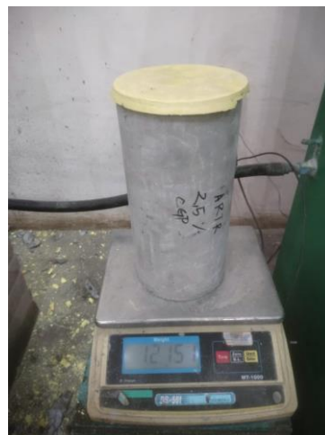
Gambar.L. 11 Pemeriksaan beton sebelum pengujian
