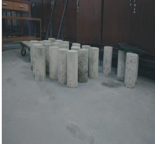
Gambar.L. 9 Pemeriksaan benda uji sebelum perendaman
