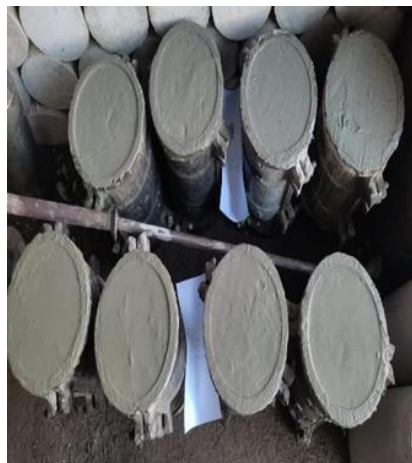
Gambar.L. 8 Beton dalam wadah cetakan silinder 15x30cm
