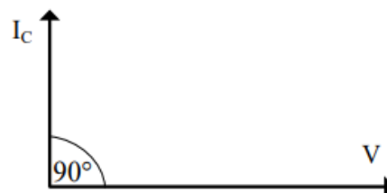
Gambar 2. 15 Vektor hubungan V dan I pada beban kapasitif( Z = XC )
