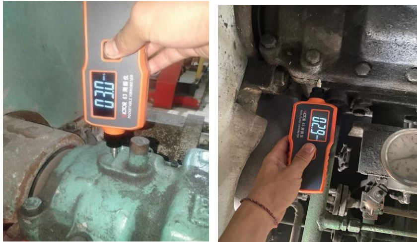
Gambar 4. 2 Hasil Pengukuran Vibrasi bearing pinion 1 pada shaft depan 0,26mm/s dan 0,30mm/s
