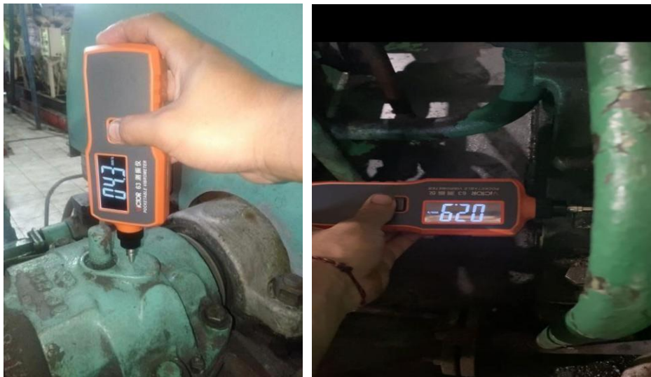
Gambar 4. 3 Hasil Pengukuran Vibrasi bearing pinion 2 pada shaft belakang 0.43mm/s dan 0.33mm/s
