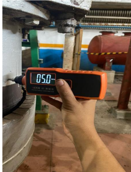
Gambar 4. 4 Hasil Pengukuran Vibrasi bearing bull gear 1 pada shaft depan 0,20mm/s dan 0,14mm/s
