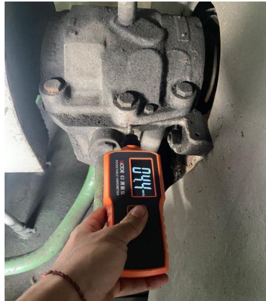
Gambar 4. 5 Hasil Pengukuran Vibrasi bearing bull gear 2 pada shaft belakang 0,27 mm/s dan 0,13mm/s
