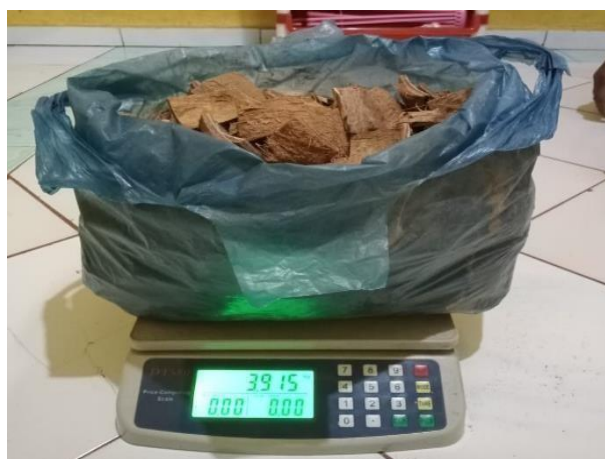
Gambar 4.8 Hasil Potongan Tempurung Kelapa 8kg yang sudah dipotong menggunakan Timbangan Digital dengan ukuran 4x4 cm
