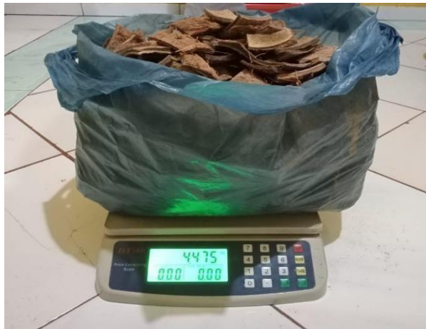
Gambar 4.12 Hasil Potongan Tempurung Kelapa 10 kg yang sudah dipotong menggunakan Timbangan Digital dengan ukuran 4x4 cm
