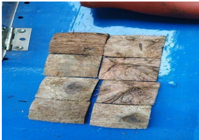
Gambar 4.4 Hasil Cacahan pemotongan Tempurung Kelapa Menggunakan Mesin Pemotongan Tempurung Kelapa Kapasitas 150 Kg/jam.
