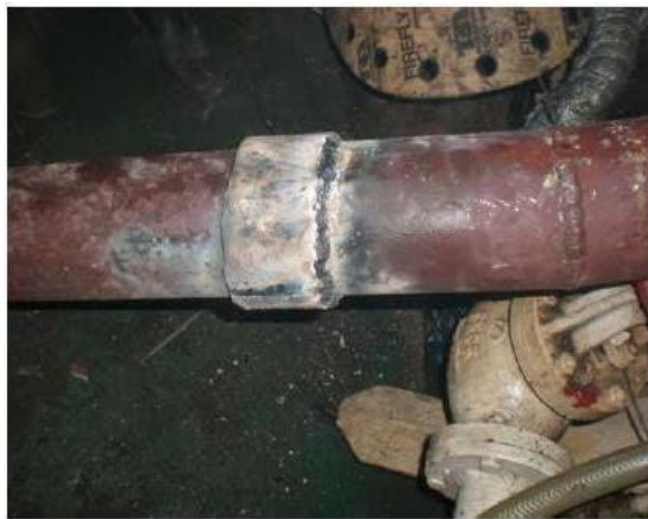
Gambar 2. 4 Korosi Galvanis (Hasyim et al., 2017)
