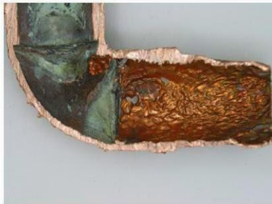
Gambar 2. 3 Korosi Erosi (Hasyim et al., 2017)
