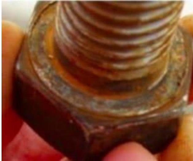
Gambar 2. 5 Korosi Celah (Hasyim et al., 2017)
