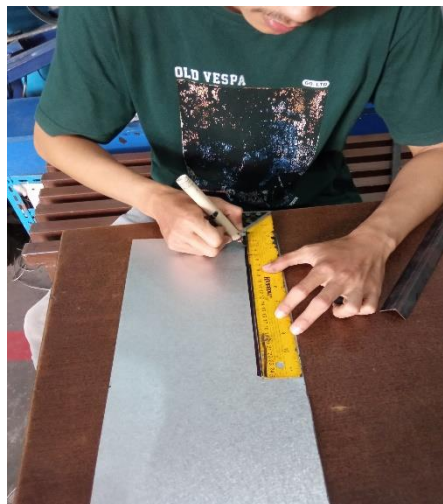
Gambar 4. 2 Mengukur plat aluminium
