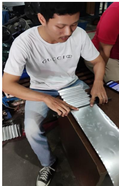
Gambar 4. 4 Proses penekukan plat aluminium
