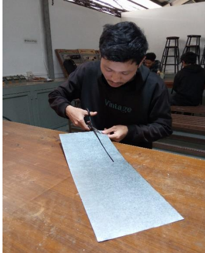
Gambar 4. 3 Memotong plat aluminium menggunakan gunting
