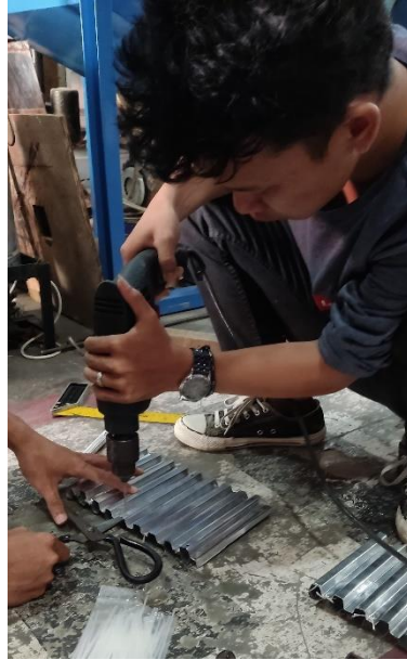
Gambar 4. 5 Melubangi plat aluminium yang telah ditekuk
