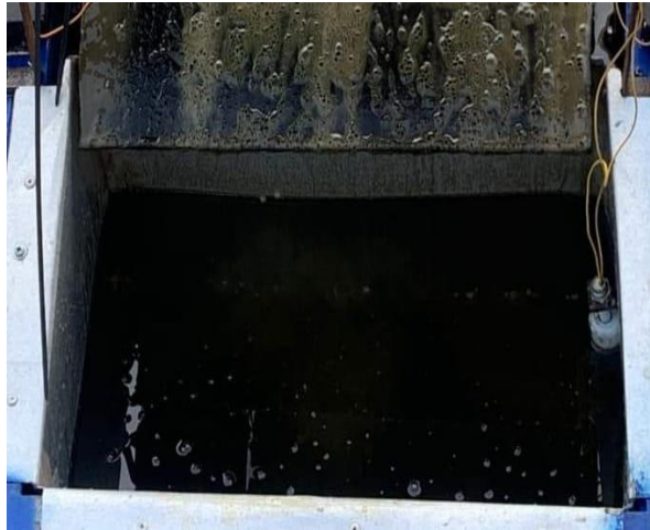
Gambar 4.9 Ketinggian Air di input melalui switch water level
