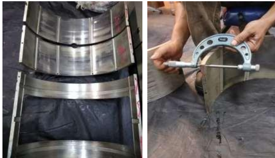
Gambar 4. 4 Proses Cleaning Bearing dan Pengukuran (PT.WSI)
