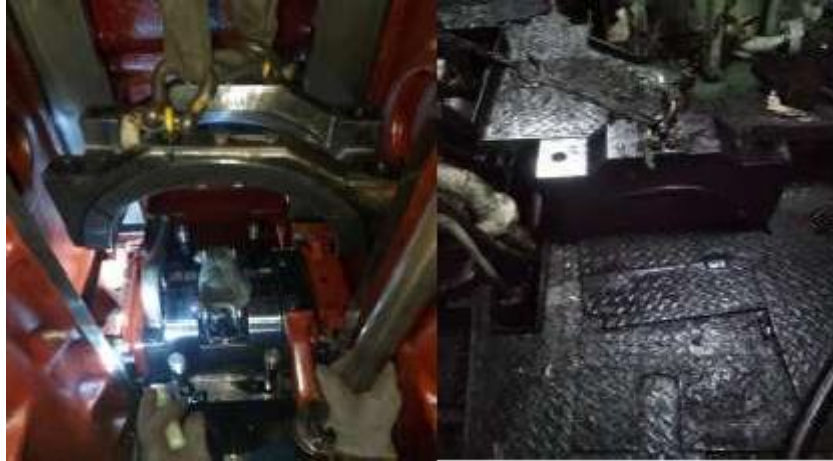
Gambar 4.3 Proses pengangkatan Cap Bearing Crosshead (PT.WSI)
