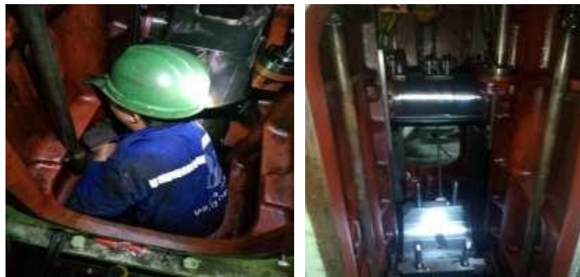
Gambar 4.6 Proses pelepasan pengikat Pin Crosshead dan Pengangkatan Pin Crosshead (PT.WSI)
