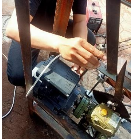
Gambar 4.32 Pemasangan motor dan gear box sebagai penggerak bandulan gerak
