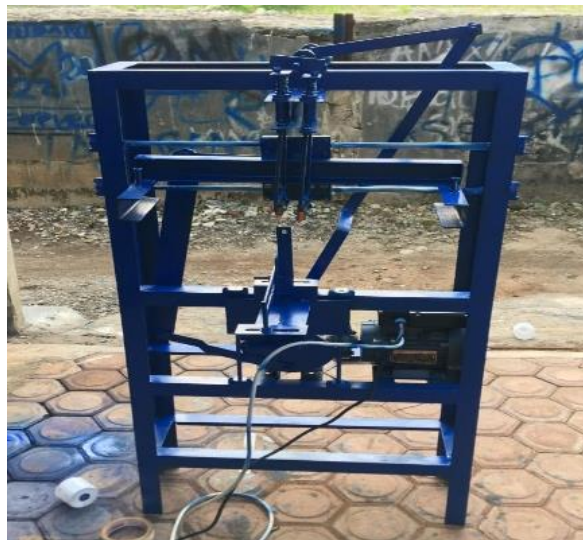
Gambar 3.35 Hasil pembuatan mesin sablon cup semi otomatis
