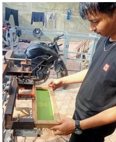
Gambar 4.33 proses Pemasangan screen ke dudukan sablon
