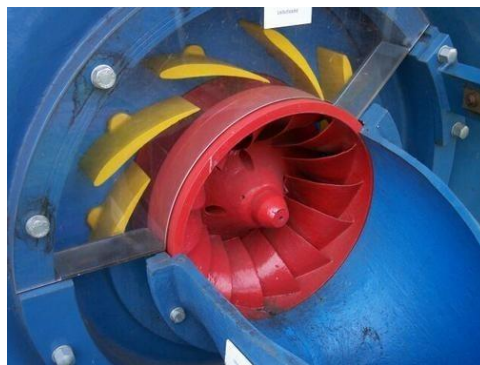
Gambar 2. 17 Sudu Pengantar ( Guide Vane )
