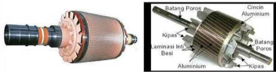
Gambar 2.8 Bagian – Bagian Rotor Sangkar
