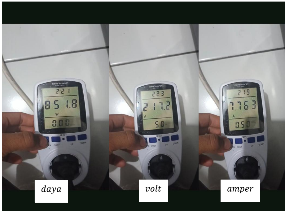
Gambar 48. Pengukuran P_l pada impeler 5 sudu di n 1418 rpm
