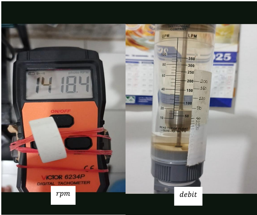
Gambar 20. Pengukuran Q pada impeler 3 sudu di n 1418 rpm
