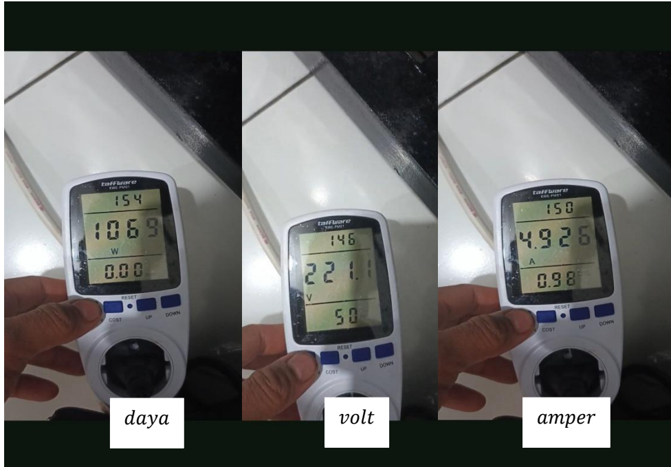
Gambar 36. Pengukuran P_l pada impeler 5 sudu di n 2868 rpm
