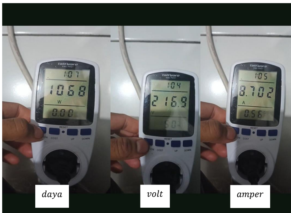
Gambar 45. Pengukuran P_l pada impeler 5 sudu di n 1741 rpm
