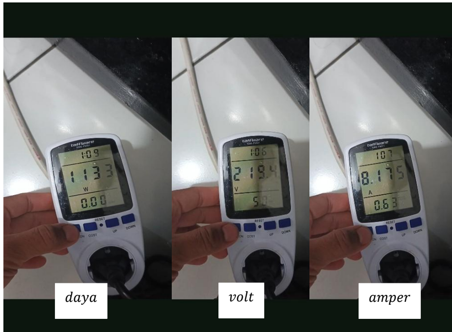
Gambar 42. Pengukuran P_l pada impeler 5 sudu di n 2157 rpm
