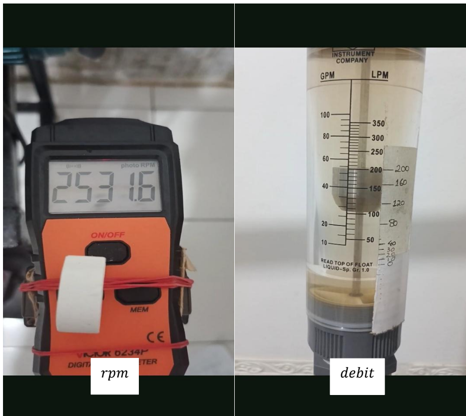
Gambar 41. Pengukuran Q pada impeler 5 sudu di n 2531 rpm
