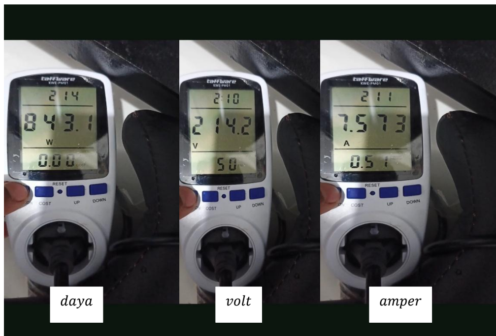
Gambar 15. Pengukuran P_l pada impeler 3 sudu di n 1741 rpm
