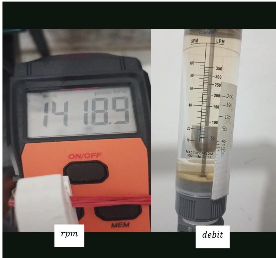
Gambar 50. Pengukuran Q pada impeler 5 sudu di n 1418 rpm
