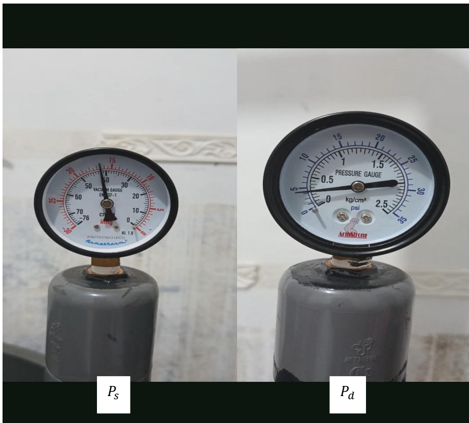
Gambar 37. Pengukuran P_s dan P_d pada impeler 5 sudu di n 2868 rpm
