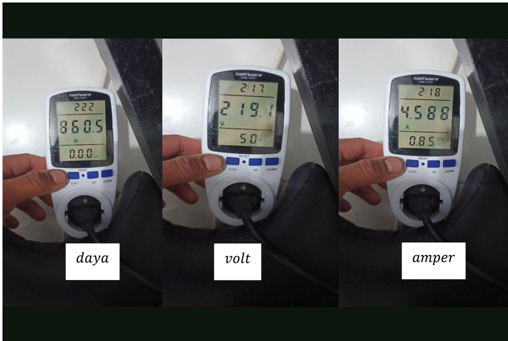
Gambar 6. Pengukuran P_l pada impeler 3 sudu di n 2868 rpm
