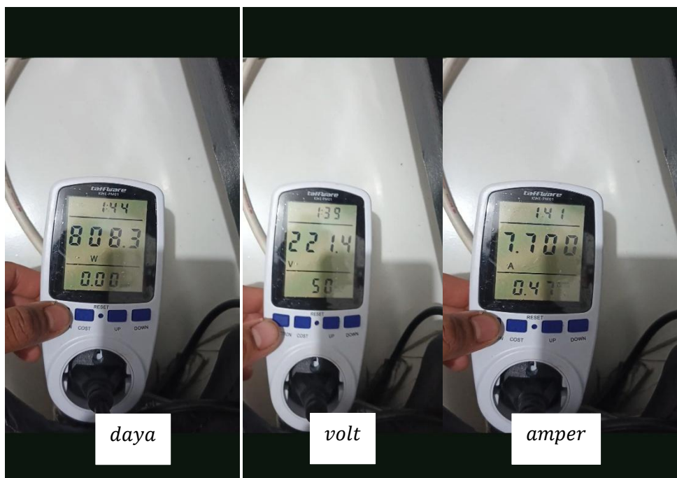
Gambar 33. Pengukuran P_i pada impeler 4 sudu di n 1418 rpm
