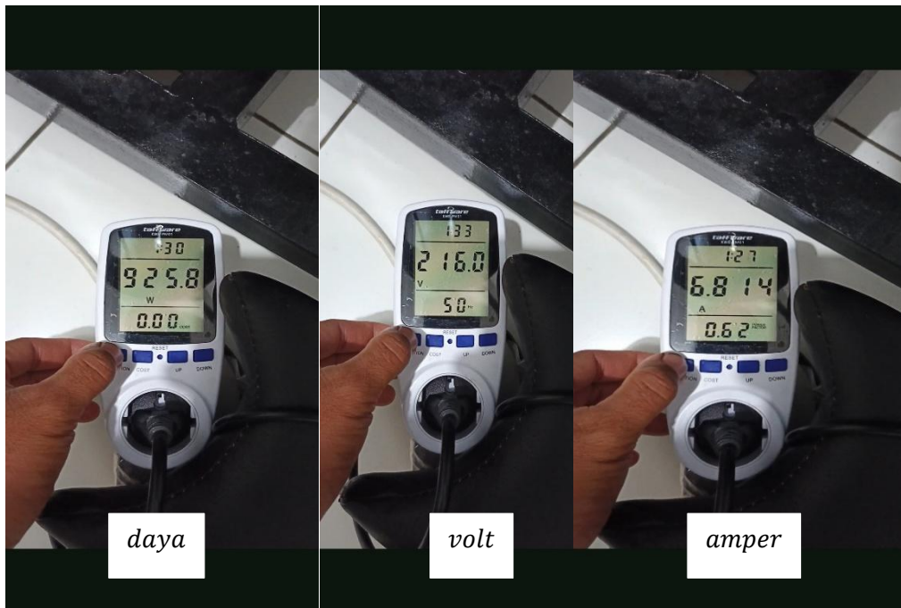
Gambar 9. Pengukuran P_l pada impeler 3 sudu di n 2531 rpm
