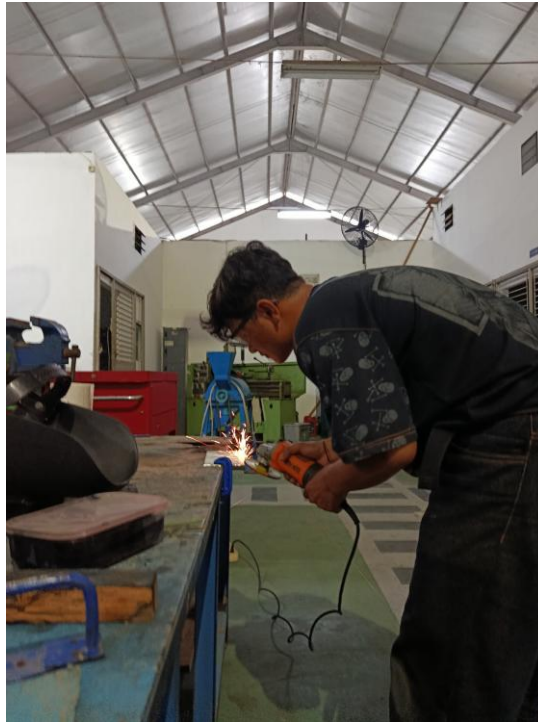
Gambar 4. 3 Proses pembentukan specimen uji Tarik
