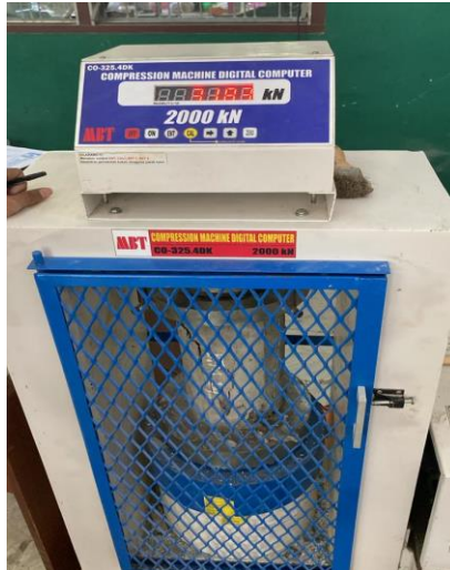
Lampiran 9: Pengujian Kuat Tekan Beton
