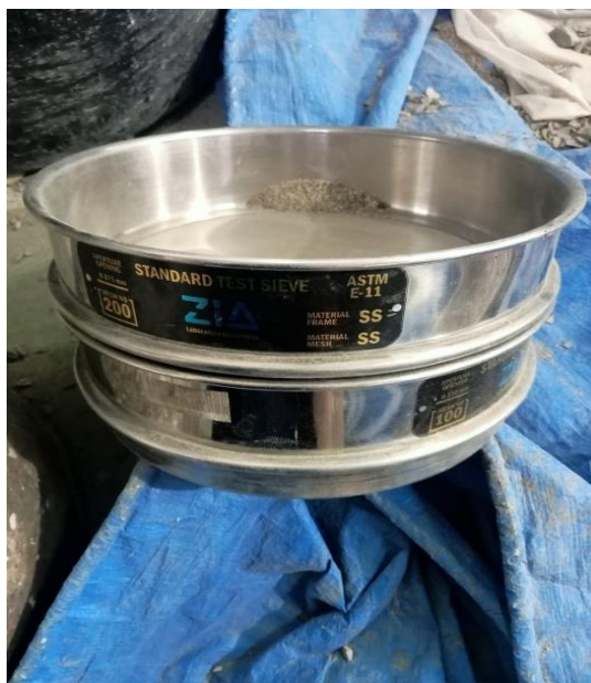
Dokumentasi 5: Saringan agregat kasar
