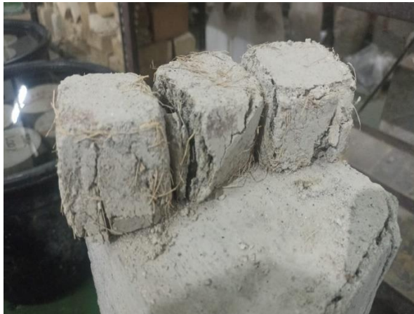
Dokumentasi 17: Pengujian kuat tekan mortar serbuk cangkang telur 6% serat buah pinang 0,75%.
