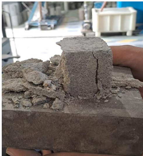
Dokumentasi 15: Pengujian kuat tekan mortar serbuk cangkang telur 9%.
