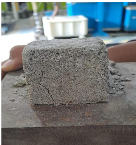
Dokumentasi 12: Pengujian kuat tekan mortar normal.
