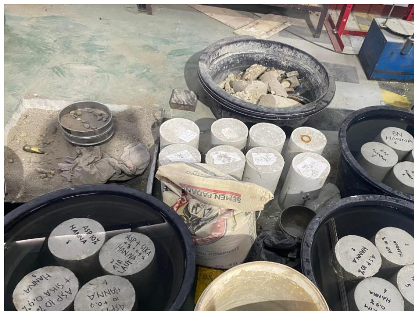
Gambar L.4: Beton perendaman air laut.
