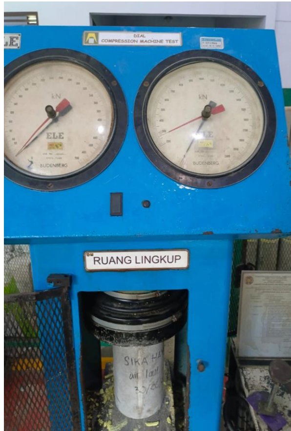
Gambar L.5: Pengujian kuat tekan beton
