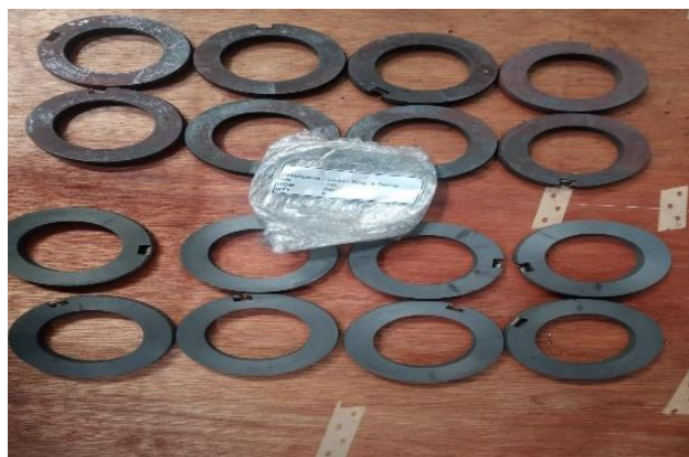
Gambar 2.12 Carbon Ring Dan Spring (PTPN III Pks Rambutan,2024)
