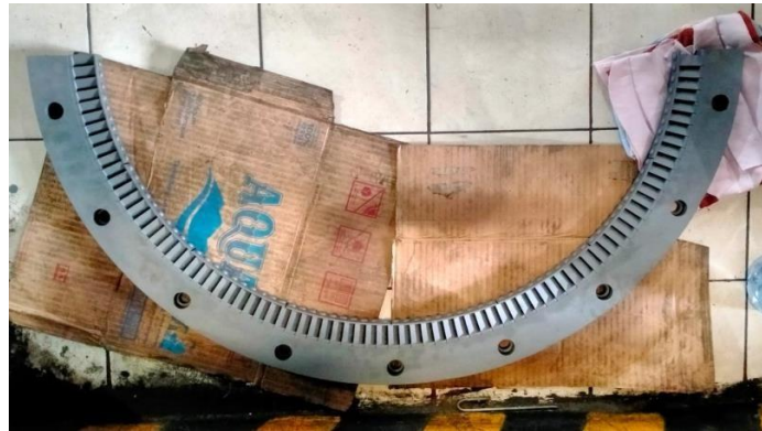
Gambar 2.16. Guide Ring (PT.Silaut Pom,2024)
