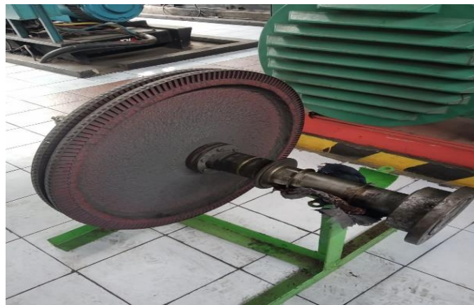
Gambar 2.7 Rotor dan Wheel (PT.Batu Ampare,2024)
