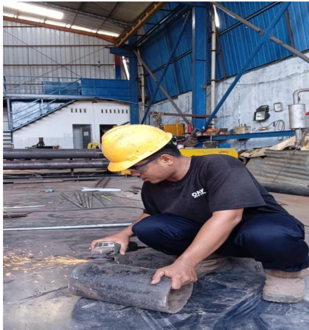
Gambar 4. 42 Menghaluskan dengan cara menggerinda bekas yang baru saja di las
