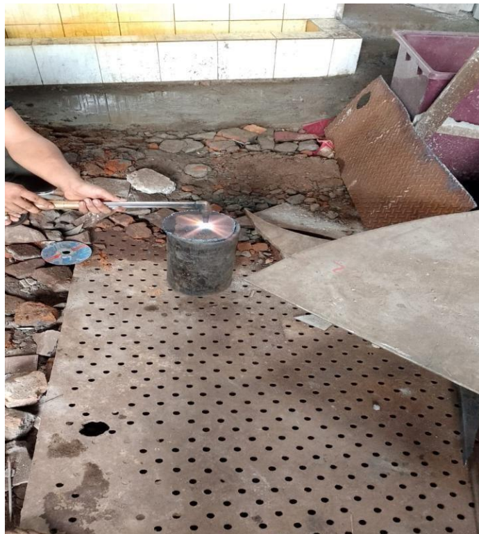
Gambar 4. 40 Membuat radius dengan cara membakar dan memukul bagian
