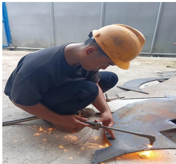
Gambar 4. 38 Pemotongan Plate Dengan Mesin Cutting
