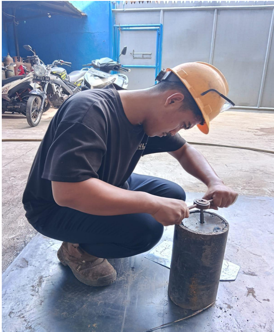
Gambar 4. 45 Membuat ulir dalam dibagian atas tengah tutup tabung
