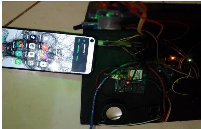
**Gambar 28. Hasil Pengujian *Sim900* saat asap diberikan pada sensor**
