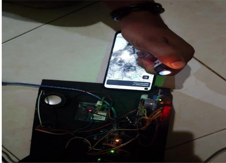
**Gambar 29. Hasil Pengujian *Sim900* saat api diberikan pada sensor**
