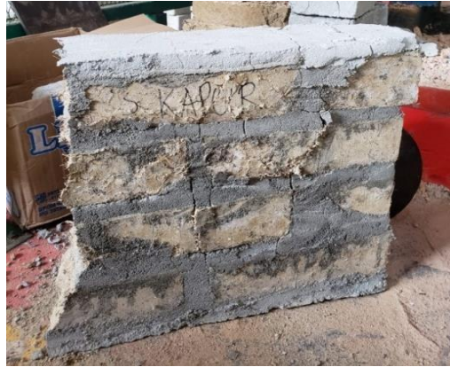
Gambar 4.16: Hasil pengujian kuat tekan pasangan bata (kapur)
