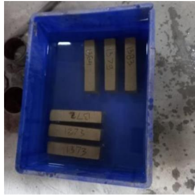
Gambar 4.7: Proses pengeringan dan perendaman bata
