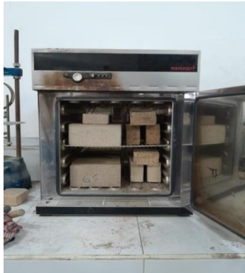
Gambar 4.7: Proses pengeringan dan perendaman bata
