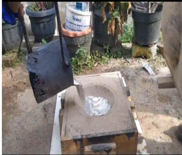
Gambar 4. 15 Proses penuangan aluminium kedalam cetakan
