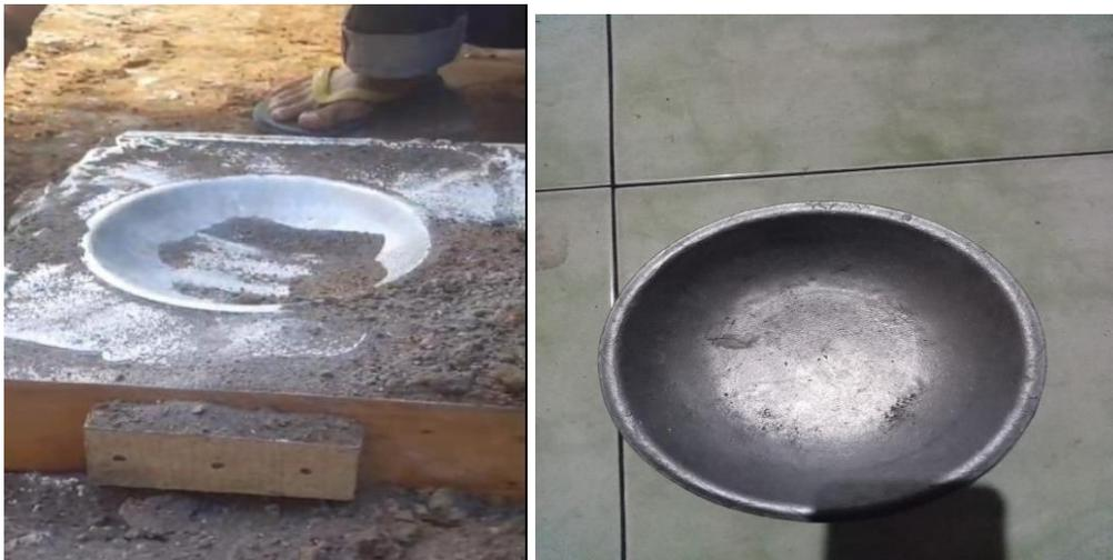
Gambar 4. 16 Hasil dari cetakan aluminium
