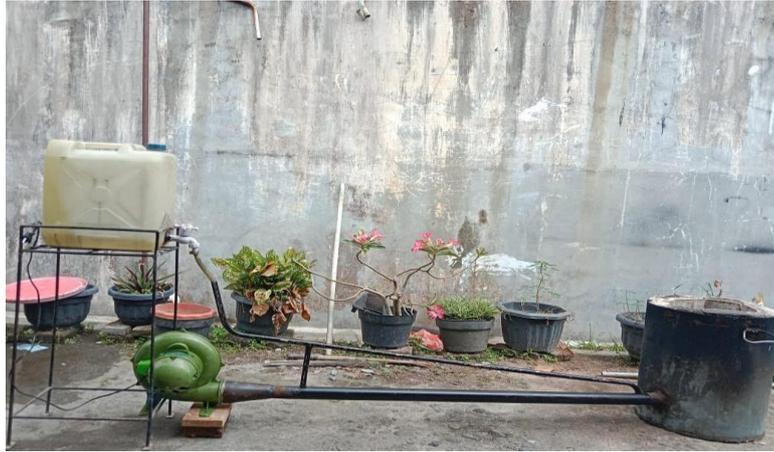
Gambar 4. 11 Hasil *assembly* dapur peleburan aluminium
