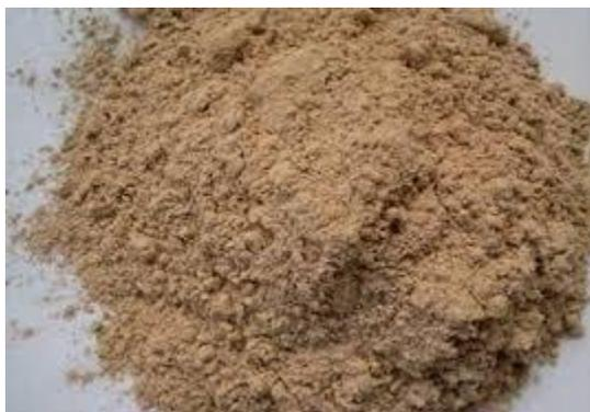
Gambar 2. 6 Refraktori mortar
