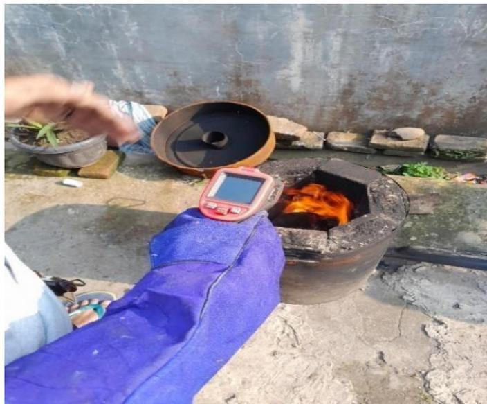
Gambar 4. 14 Proses pengukuran temperatur dengan *thermogun infrared*
