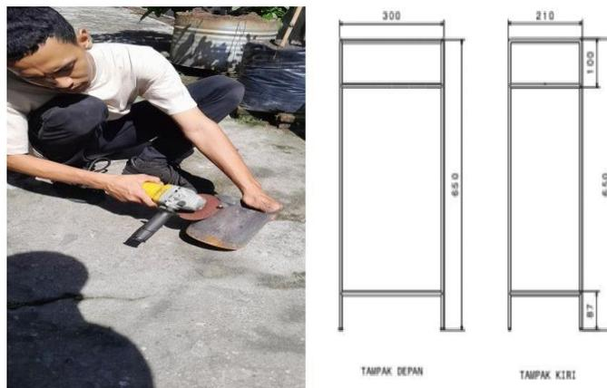
Gambar 4. 2 Memotong besi beton sesuai ukuran yang diperlukan
