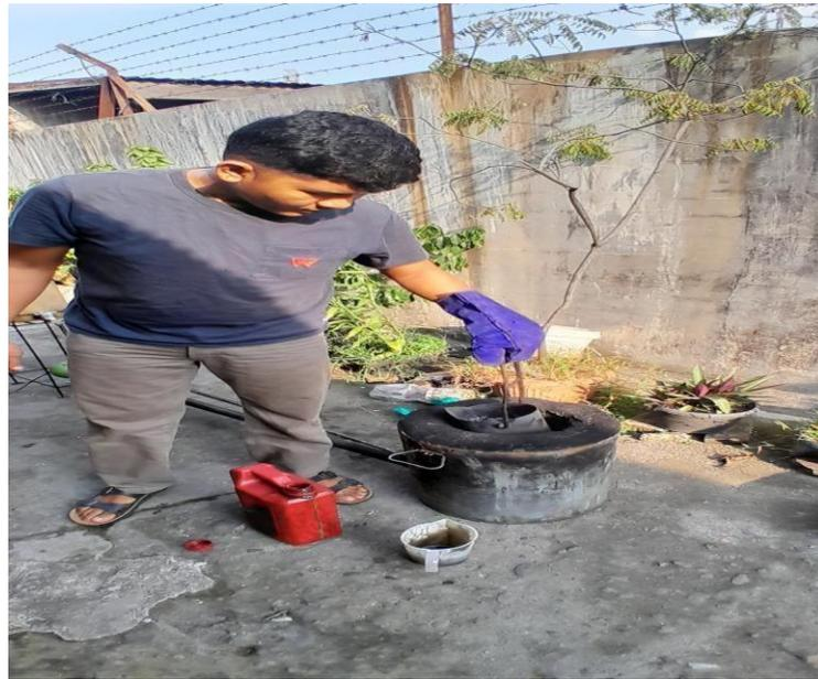
Gambar 4. 13 Menempatkan kowi ke tengah tungku peleburan
