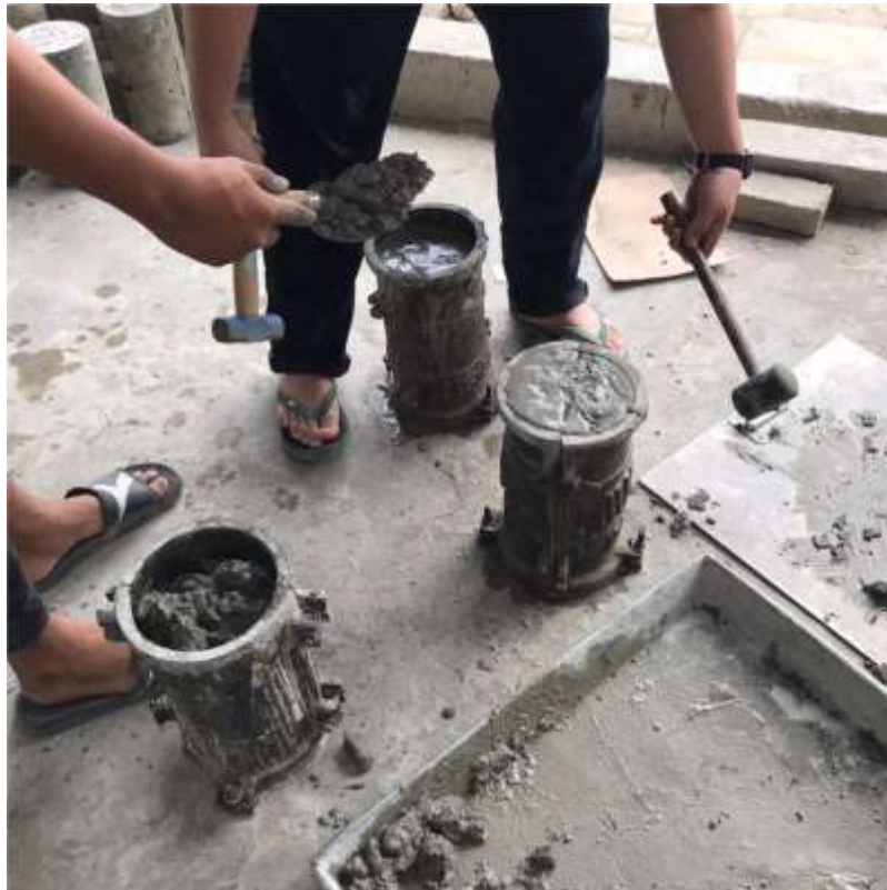
Gambar L.15 : Beton segar dimasukkan ke dalam bekisting
