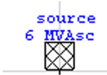
Gambar 2.5 Power Grid pada ETAP
