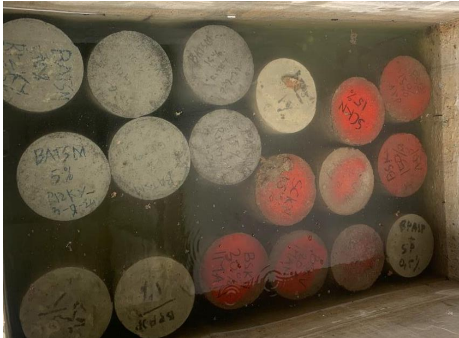
Gambar L.7: Benda uji silinder saat perendaman
