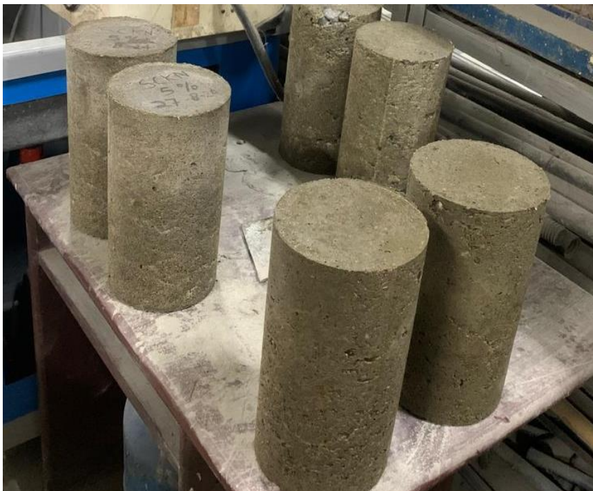
Gambar L.8: Benda uji silinder akan ditimbang sebelum diuji
