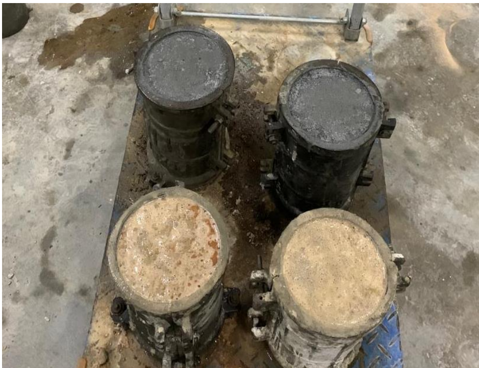
Gambar L.6: Beton segar dimasukkan ke dalam bekisting
