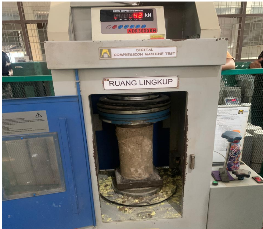
Gambar L.9: Pengujian kuat tekan beton
