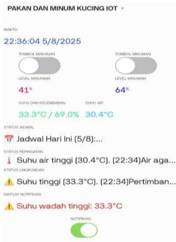
Gambar 4.9 Tampilan Antarmuka Blynk yang Menunjukkan Suhu dan Kelmbapan Wadah Makanan (V4), Suhu Air (V5)
