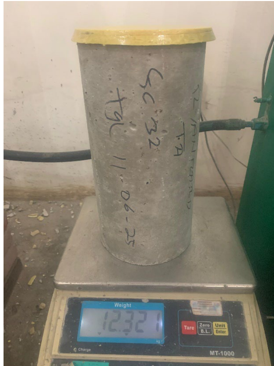
Gambar L. 13: Penimbangan Benda Uji
