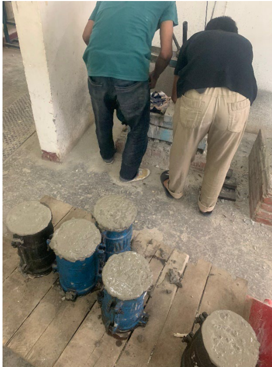
Gambar L. 7: Beton Segar Setelah Masuk Ke Bekisting
