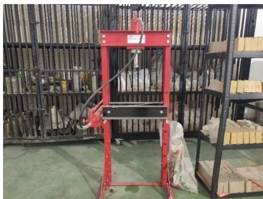
Gambar 3.8 : Mesin Hidrolik Press (Pompa Hidrolik).
