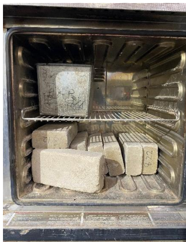
Gambar 4.12: Proses Pengeringan Benda Uji
