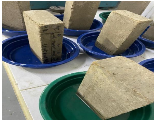
Gambar 4.6: Kondisi Bata Setelah Di Uji Kadar Garam.
