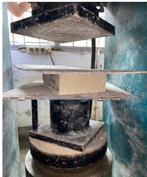
Gambar 4.8: Proses Pengujian Kuat Tekan.
