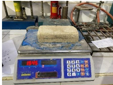
Gambar 4.14 Benda Uji Setelah Direndam
