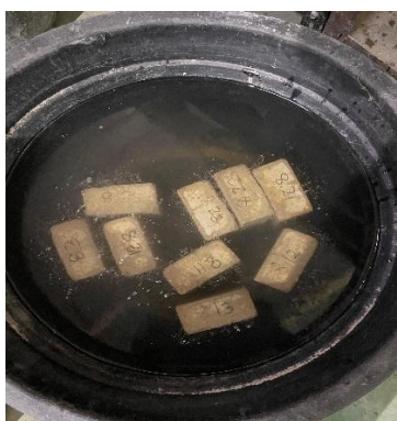
Gambar 4.13 Proses Perendaman Benda Uji
