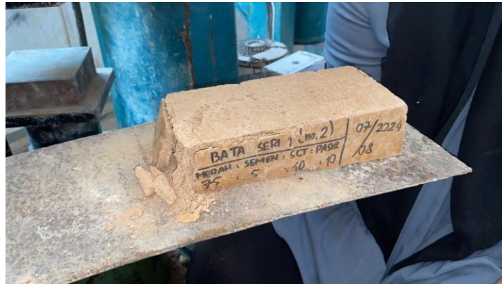
Gambar 4.9: Setelah Pengujian Kuat Tekan.
