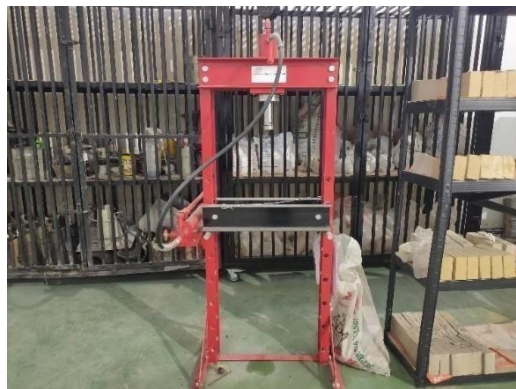
Mesin Hidrolik Press (Pompa Hidrolik).
