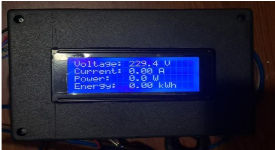
Gambar 4.23 Sistem Monitoring Parameter Listrik Berbasis Arduino Nano
