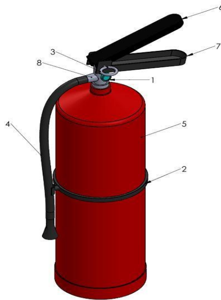
Gambar 4. 1 Hasil perancangan dari tabung APAR (Alat Pemadam Api Ringan)
