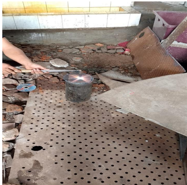
Gambar 4.3.3 Membuat radius dengan membakar dan memukul bagian dalam
