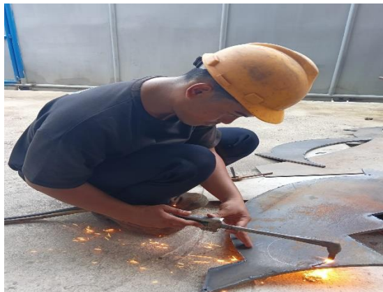
Gambar 4.3.1 Pemotongan Plate Dengan Mesin Cutting
