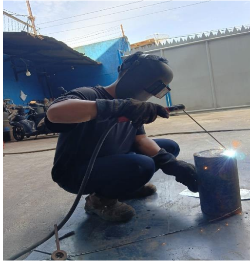
Gambar 4.3.4 Pengelasan penyambungan alas tabung dengan pipa carbon steel
