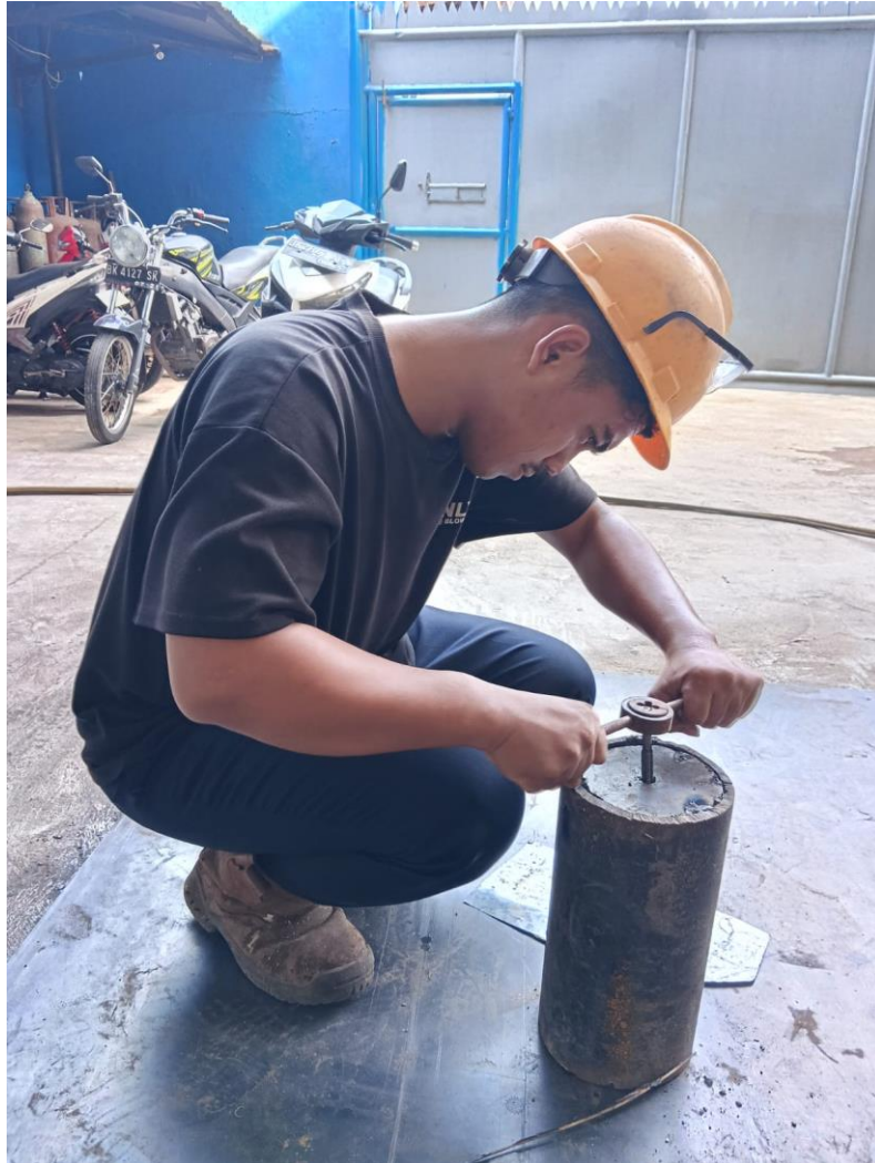
Gambar 4.3.8 Membuat ulir dalam di bagian atas tengah tutup tabung
