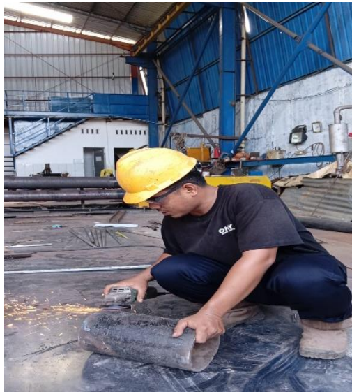
Gambar 4.3.5 Menghaluskan dengan cara menggerinda bekas yang baru saja dilas
